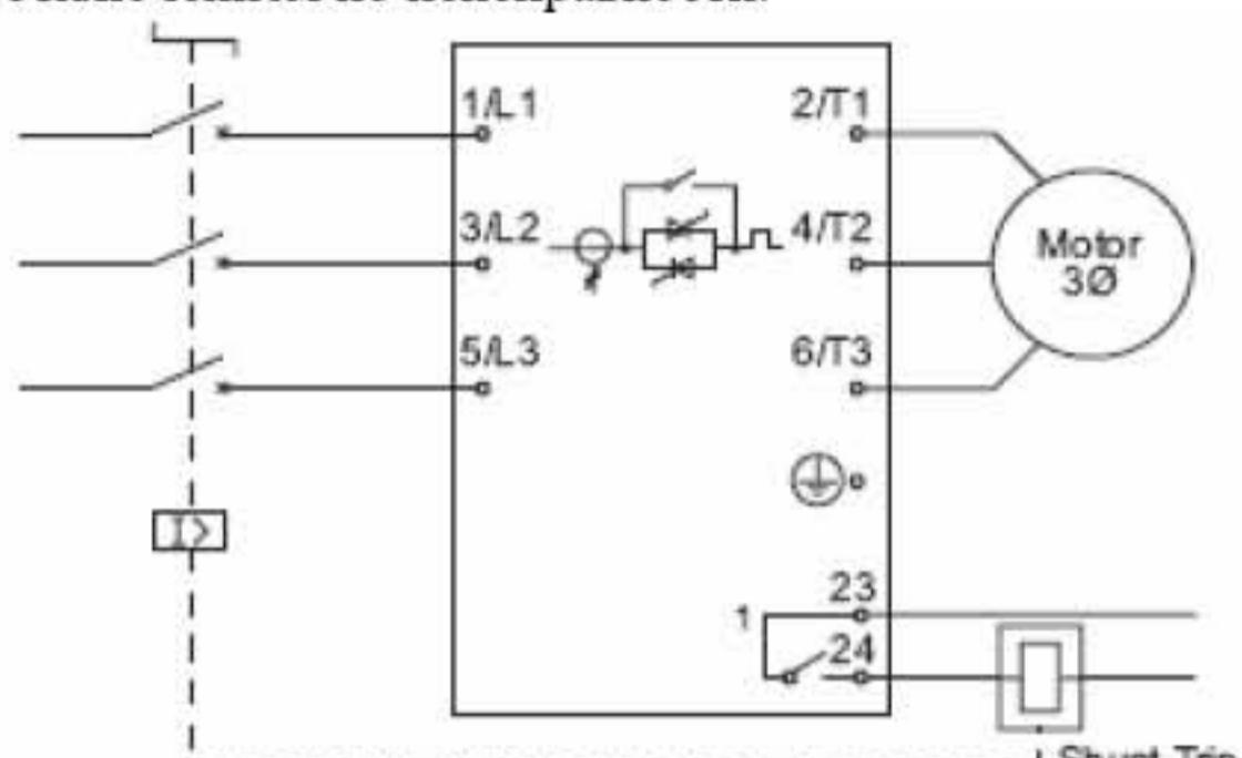
Реле 1 – реле по неисправности
